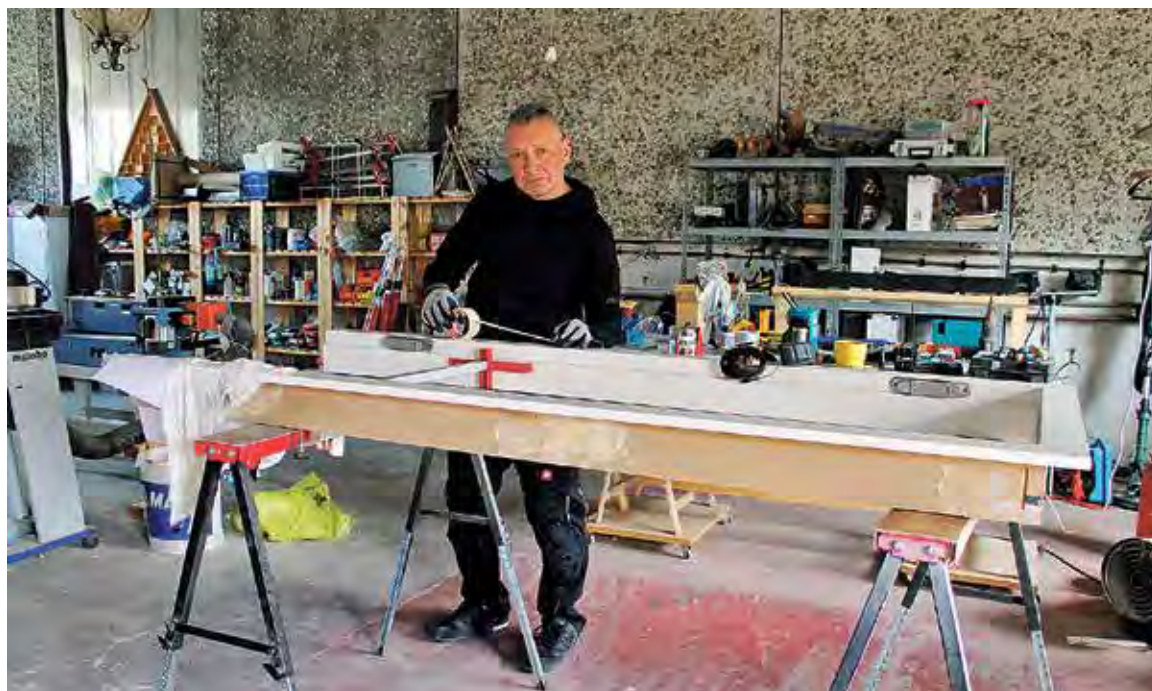
Jens Heinemann klebt den aufgearbeiteten Türrahmen ab, den er anschließend lackiert.
