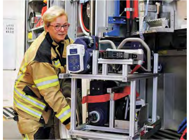
Das HLF ist auch vollgepackt mit jeder Menge technischer Hilfeleistung – wie diesem hydraulischen Rettungsgerät.
