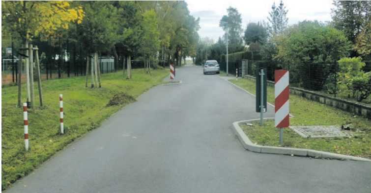
Vorzugsweise erfolgt der Einsatz von versetzt angeordneten, beidseitigen Einengungen
